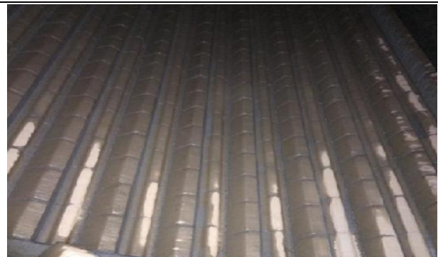
图39: 公司复合衬板在额尔登特铜矿球磨机的应用
